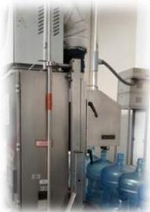
Mediante un equipo de nariz electrónica se analiza la presencia de contaminación por olor en el envase. Si se detecta un envase contaminado, se realiza el rechazo de manera automática mediante un pistón.
