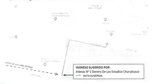
Para ingresar al edificio será necesario se realice una canalización subterránea de 6 metros de longitud aproximadamente para pasar el estacionamiento, misma que deberá estar al menos 15cm por debajo del pavimento existente dentro de Canal 22\*.
