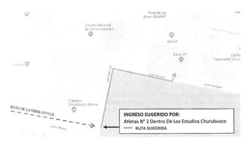
Para ingresar al edificio será necesario se realice una canalización subterránea de 6 metros de longitud aproximadamente para pasar el estacionamiento, misma que deberá estar al menos 15cm por debajo del pavimento existente dentro de Canal 22\*.
